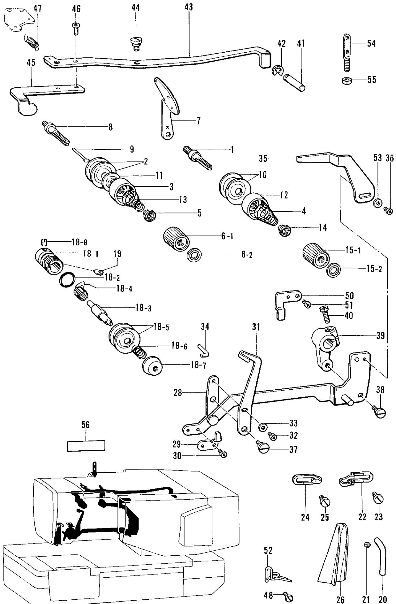
T. 糸通シ関係/Threading mechanism/Fadenführungs vorrichtung/
