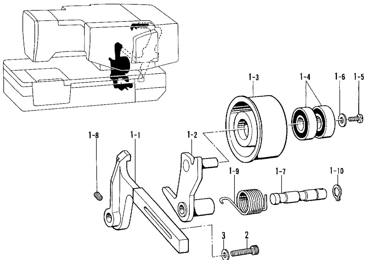
K. カム伝導関係 / Feed cam mechanism / Transporteurkurve /
