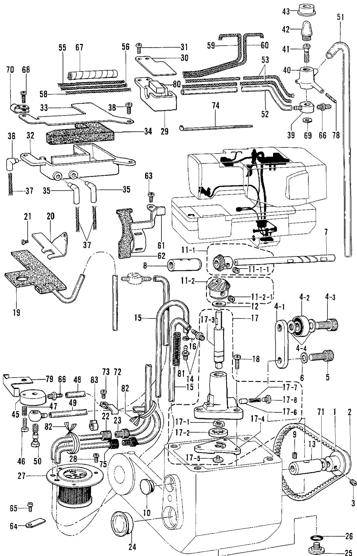
S. 給油潤滑関係/Lubrication/Schmierung/
