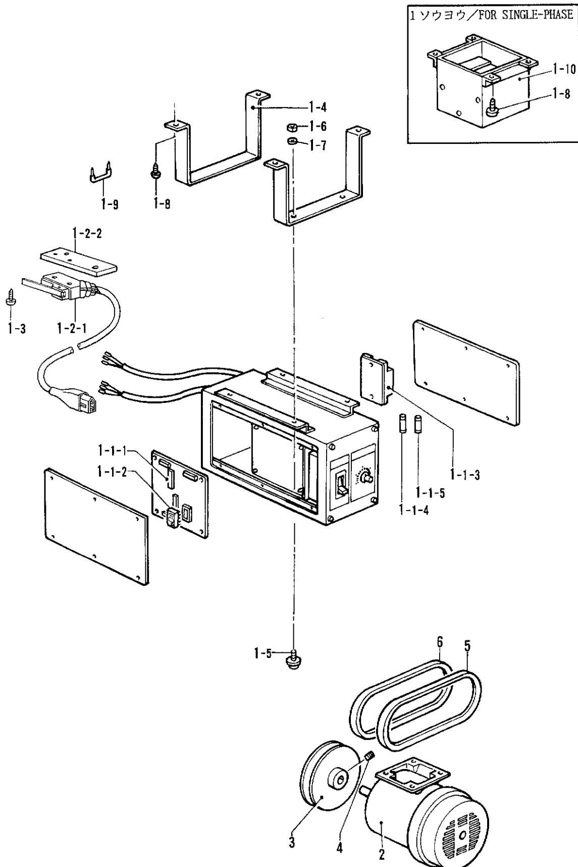
Y. 可变速モータ装置 /Variable speed motor device/Motoreinheit für variable drehzahl/
