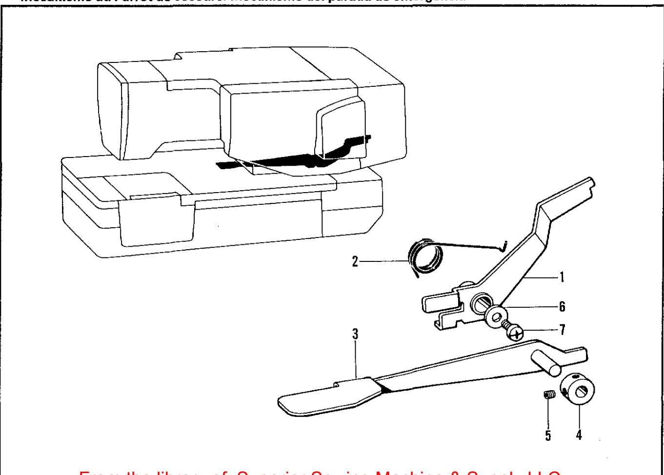
**G. ベルト寄セ関係 / Belt shift mechanism / Riemenumstellvorrichtung /
