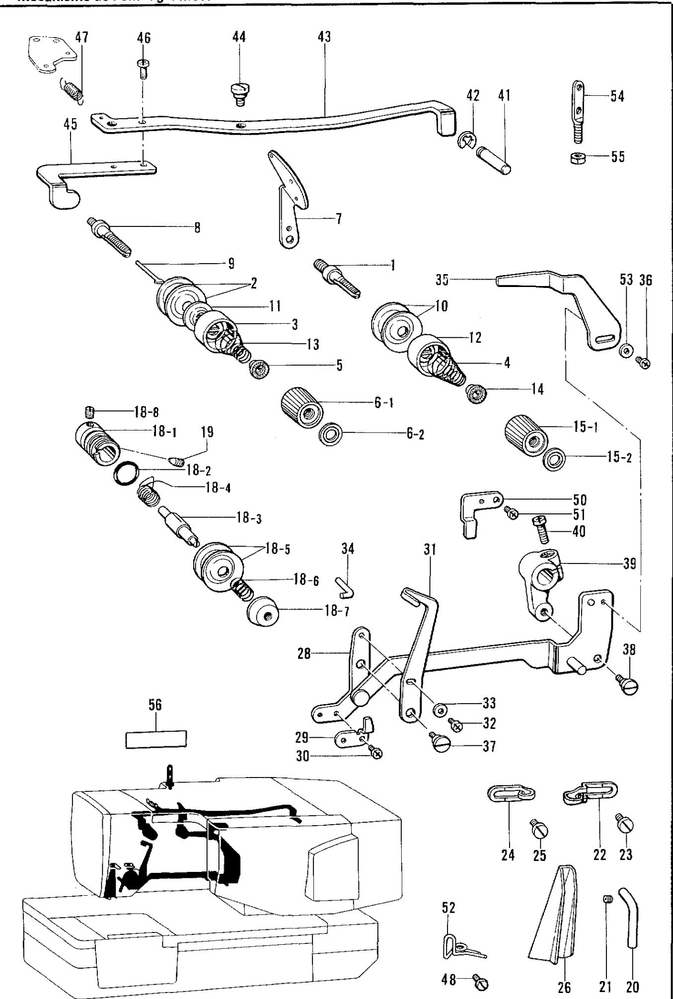
T. 糸通し関係 / Threading mechanism / Fadenführungs vorrichtung /
