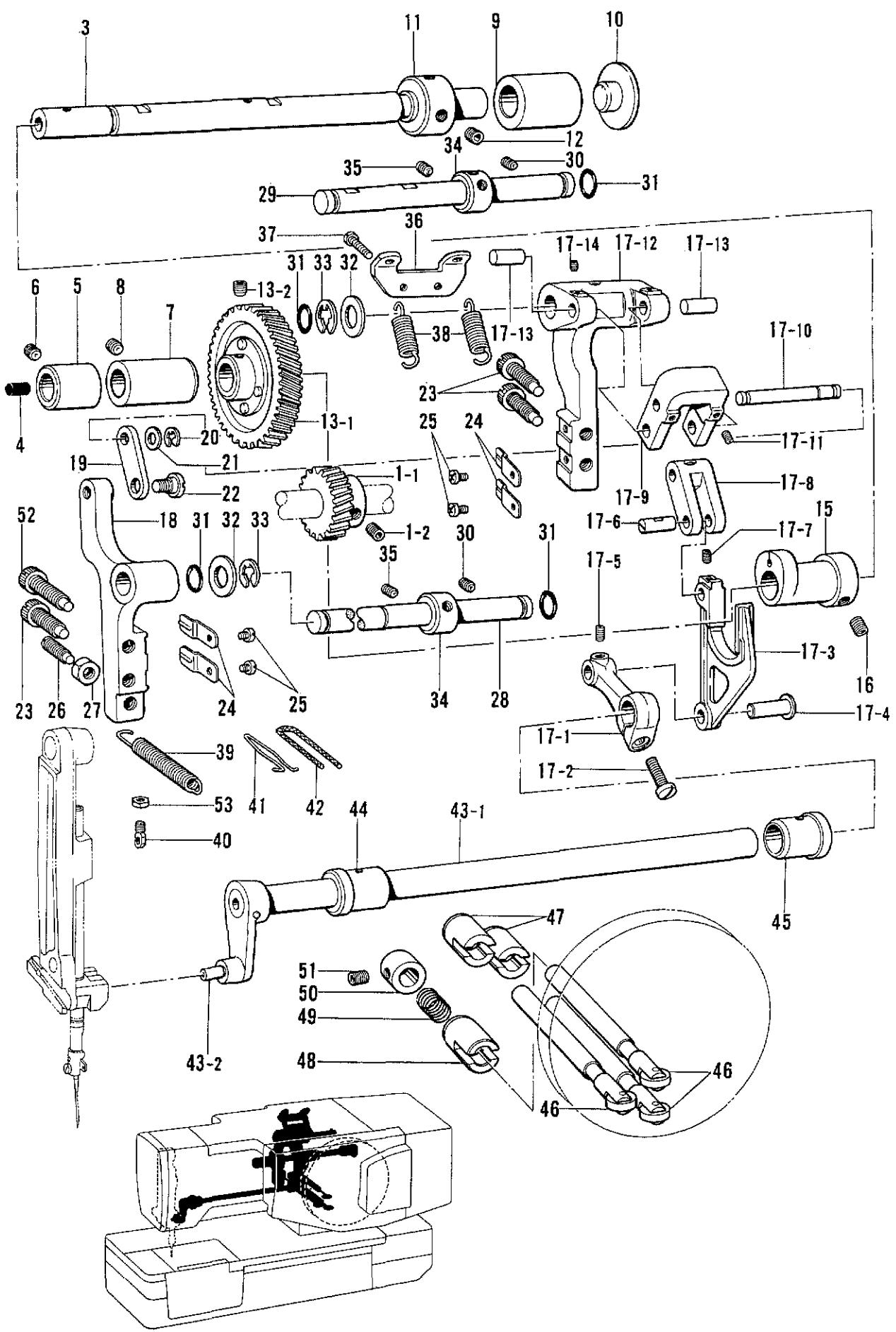
C. 針振関係 / Zigzag mechanism / Zickzackvorrichtung /
