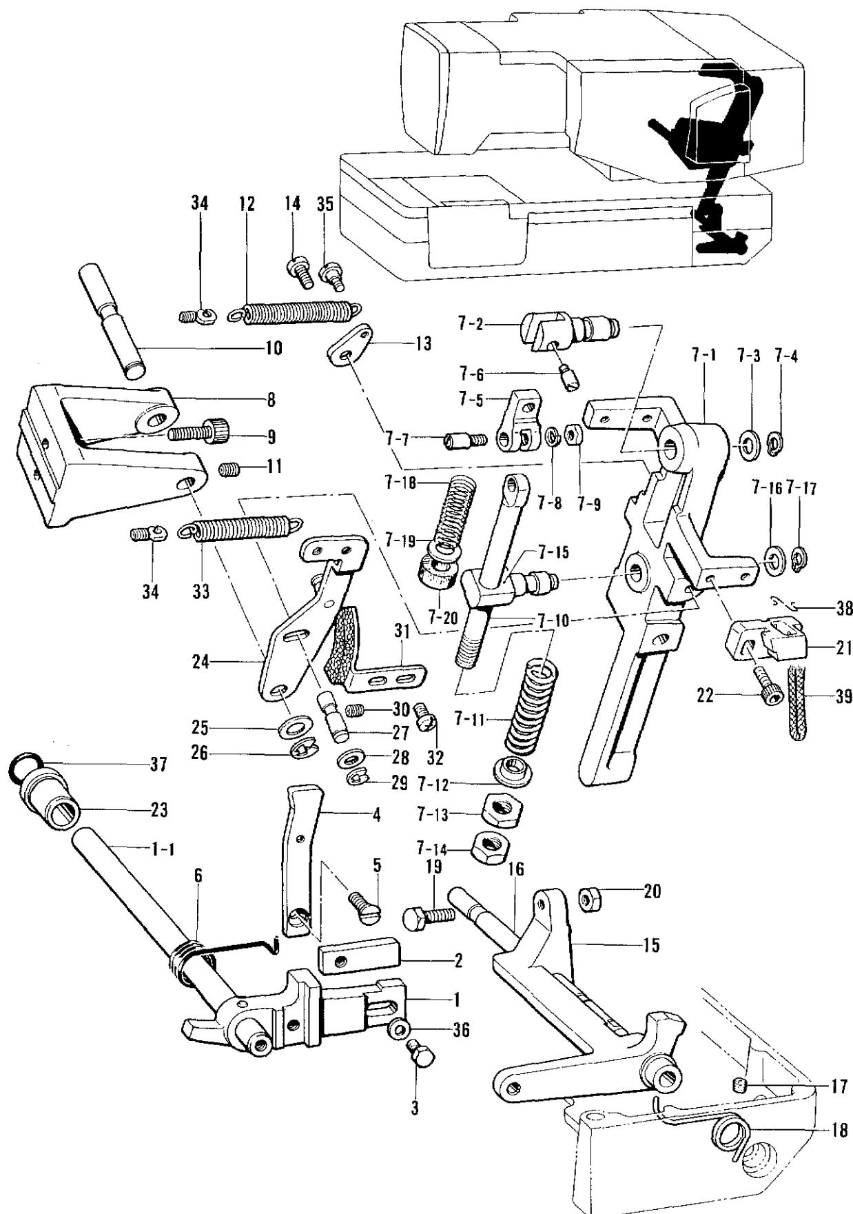
F. 停止関係 / Clutch mechanism / Kupplungsvorrichtung /
