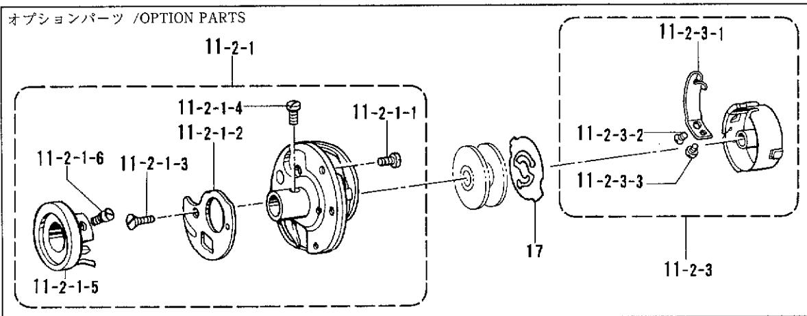
R. カマ関係 / Rotary hook mechanism / Greifervorrichtung /
